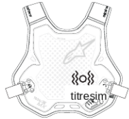
Şekil 26: Sistemi Kapatmak İçin Ekran Düğmesine (3a) 5 Saniye Basın (alternatif kapatma yöntemi)
