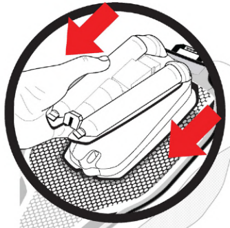
Şekil 17: Hava yastığının ve tüm elektronik bileşenlerin Sistemin arkasından çıkarılması
